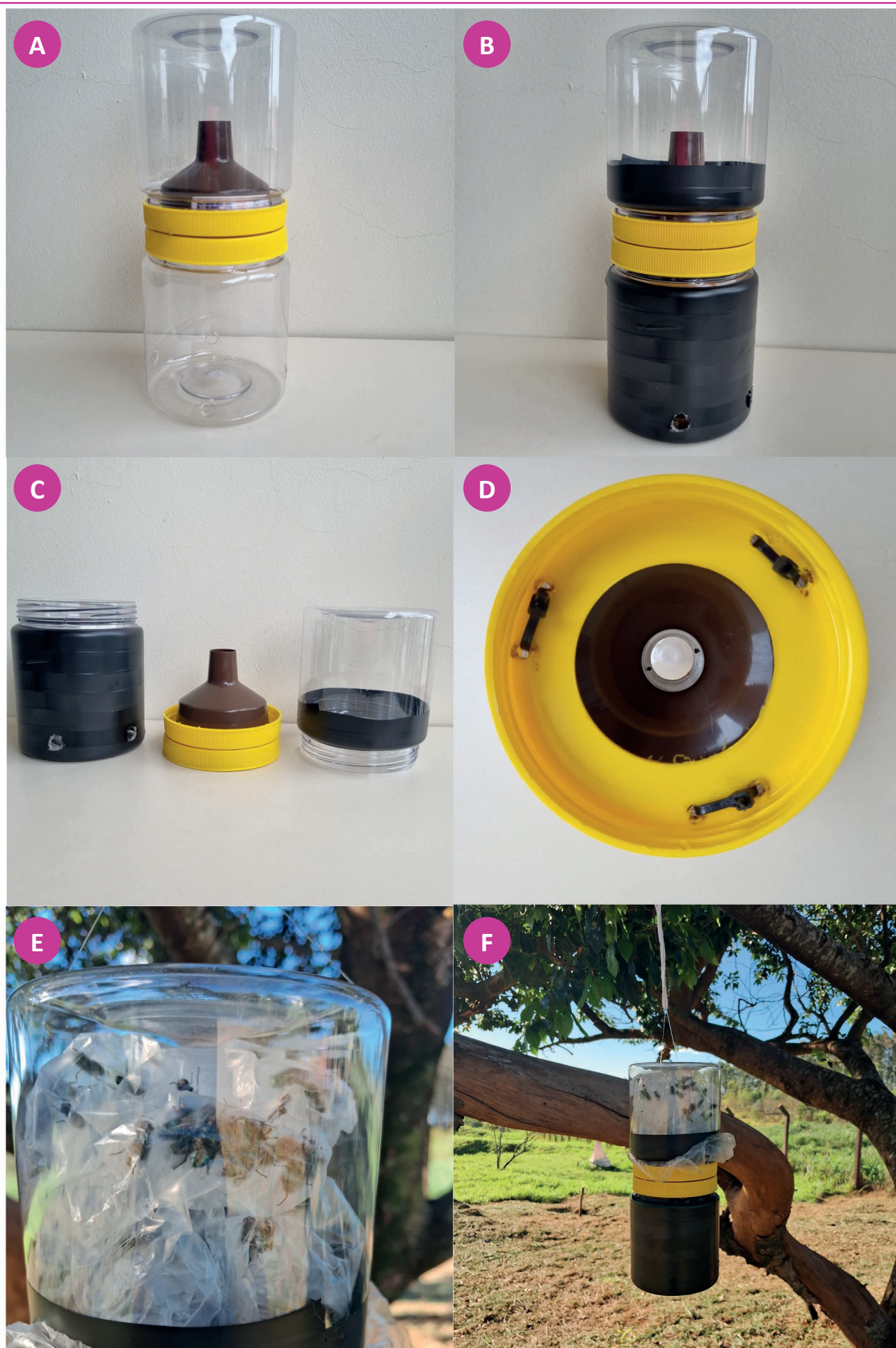
Figura 1. Armadilha atrativa modificada (A), pote inferior escurecido com fita isolante (B), partes desmontadas (C), vista interna da tampa e entrada do adaptador (D), parte superior com espécimes em saco plástico interno (E) e armadilha em campo (F).
